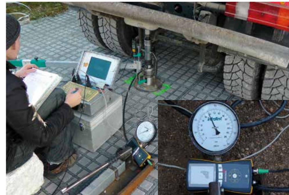
Bild 1: Durchführung Lastplattendruckversuch mit Messung der reduzierten Belastung am Bodenplanum
